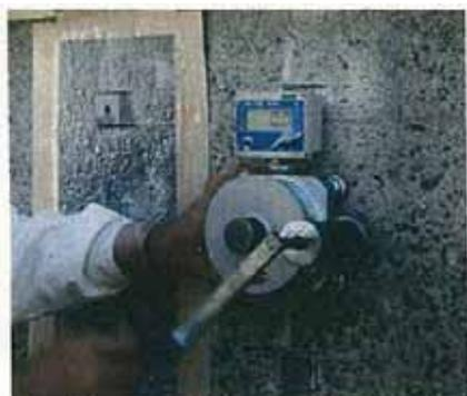
図 6.3-11 建研式引張試験装置
