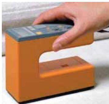
図 6.3-15 高周波容量式水分計の例
