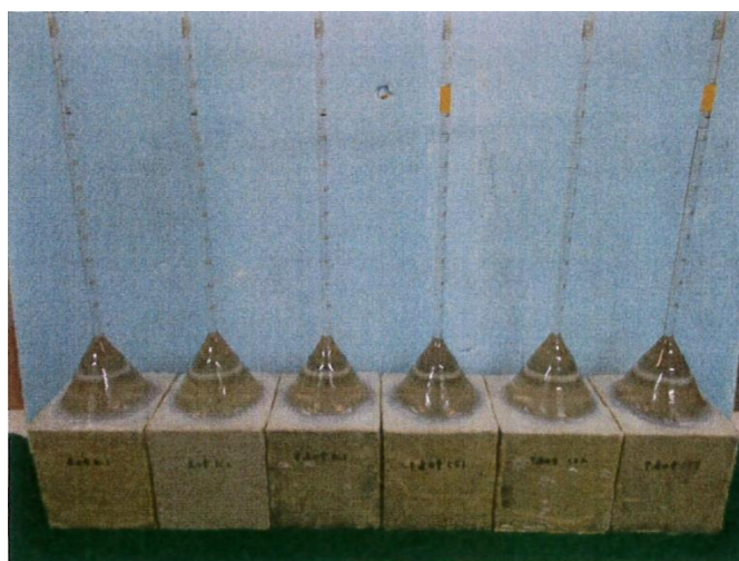
写真8 透水量試験状況
