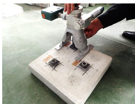
写真 14 表層引張強度試験状況
