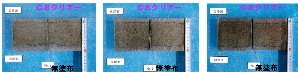
写真 10 塩化物イオン浸透に対する抵抗性試験、割裂断面（試薬噴霧後）
