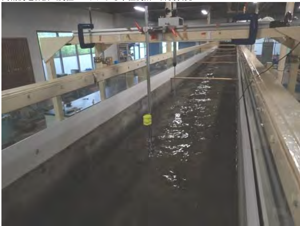
高精度超音波式変位センサによる水位変動の計測状況
