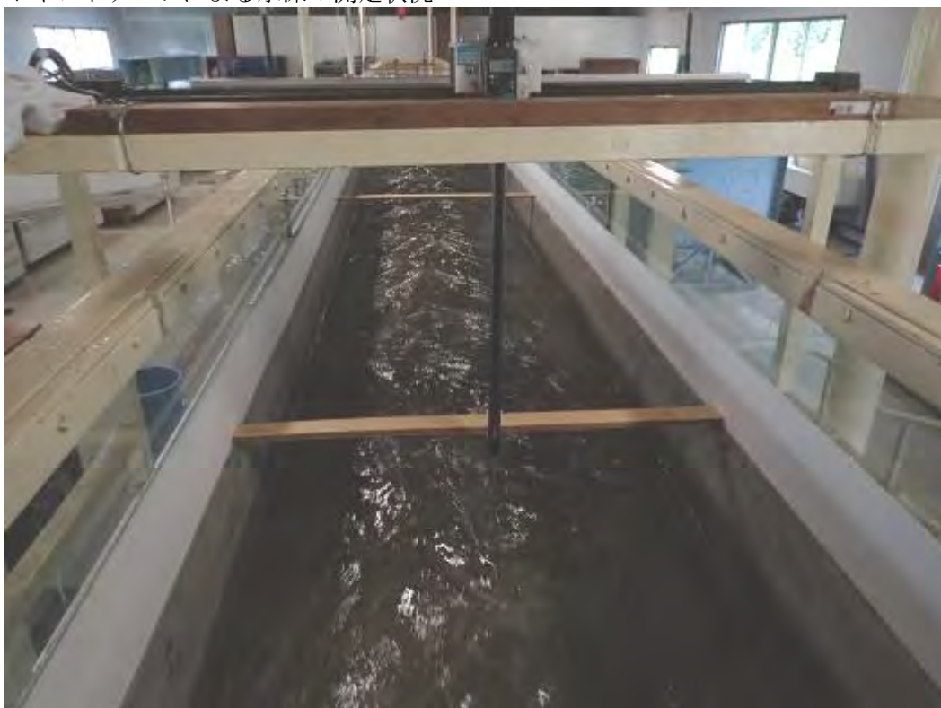
ポイントゲージによる水深の測定状況
