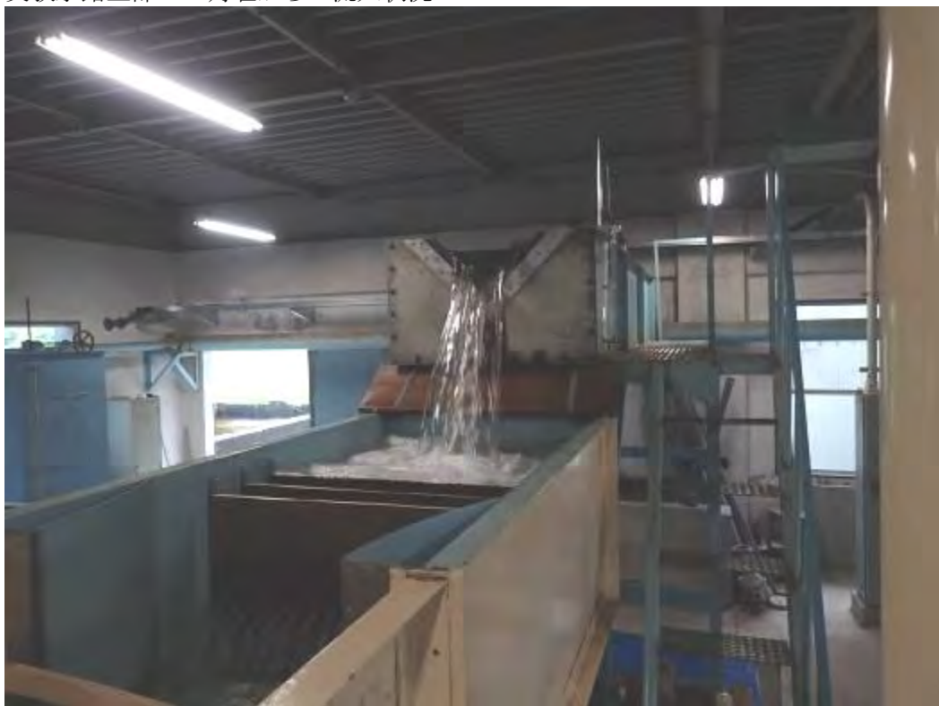
実験水路上部の三角堰からの流入状況
