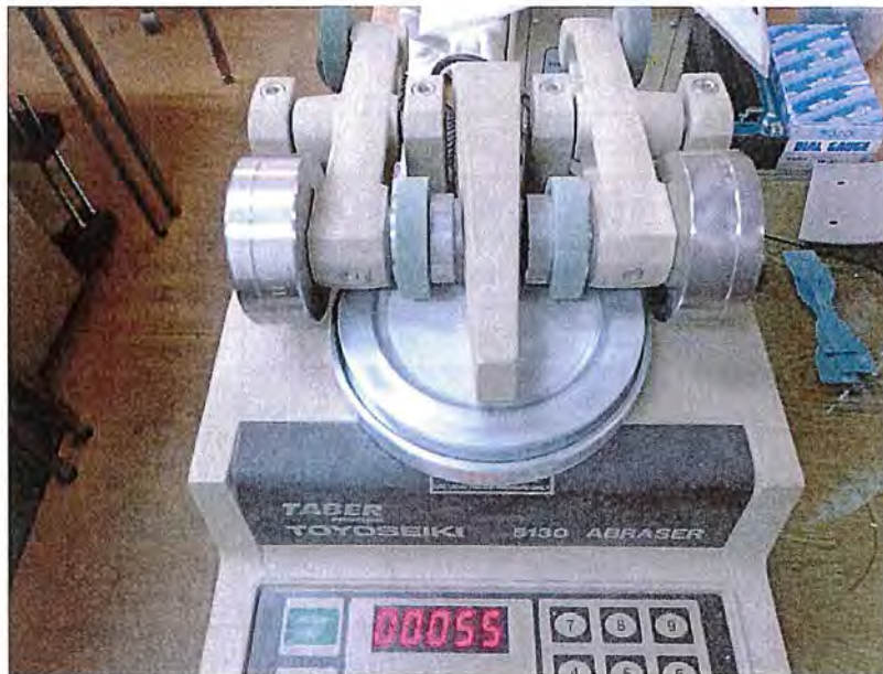
写真-15 摩 耗 試 験 状 況
