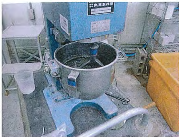
写真-3 供試体の作製状況 [練混ぜ状況]
