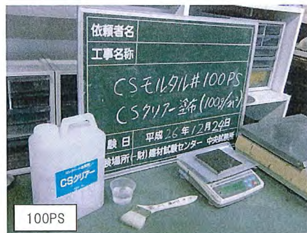
写真-6 供試体の作製状況 [100PS：成形状況]
