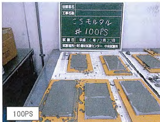
写真-6 供試体の作製状況 [100PS：成形状況]
