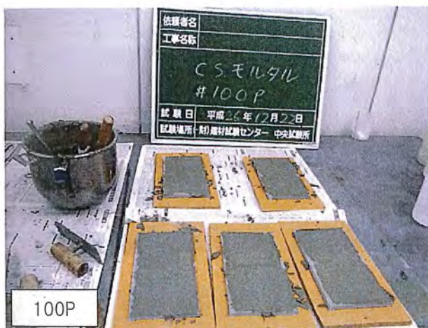
写真-5 供試体の作製状況 [100P：成形状況]
