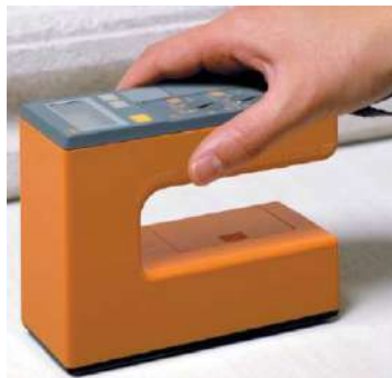
写真 11.5.1-6 高周波容量式水分計の例
