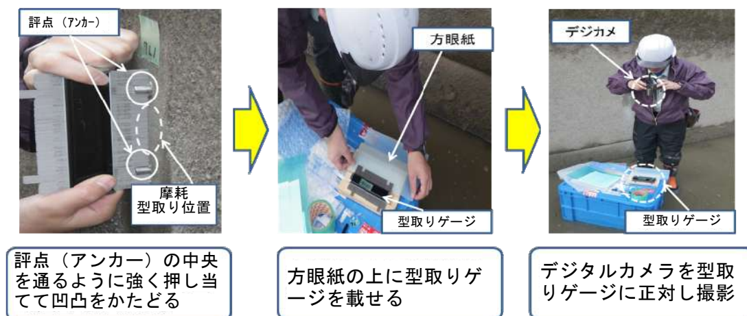
写真11.5.1-3 型取りゲージの型取り及び撮影
