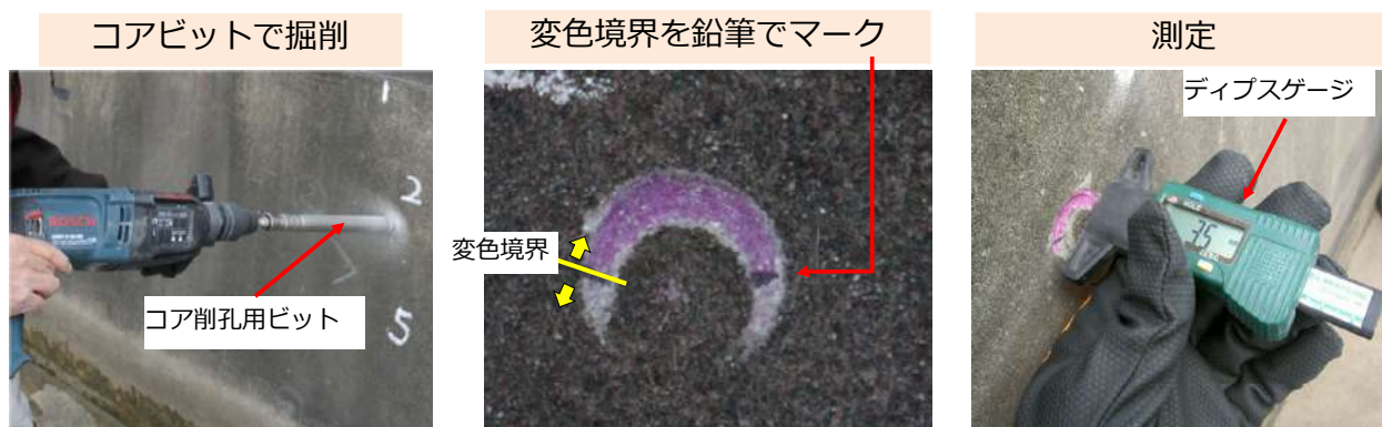
写真 11.5.1-5 小口径コア法の概要
